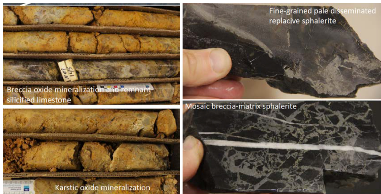
Abb. 1: Linkes Bild: Hochgradige Zinkoxidmineralisierung in Bohrloch SRDD-2018-001. Rechtes Bild: Feinkörniger Sphalerit mit geringem Eisengehalt in schwarzem Schiefer in Bohrloch SRDD-2018-004
